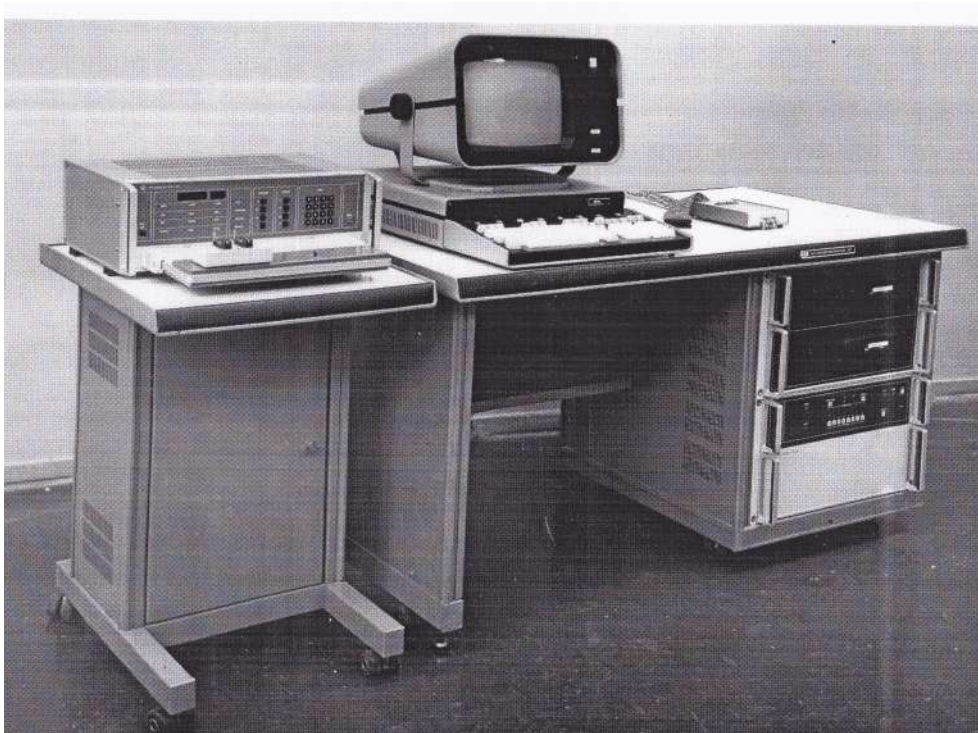
← Рисунок 2.6 – Технологическая радиоэлектронная система, созданная с использованием агрегатирования
