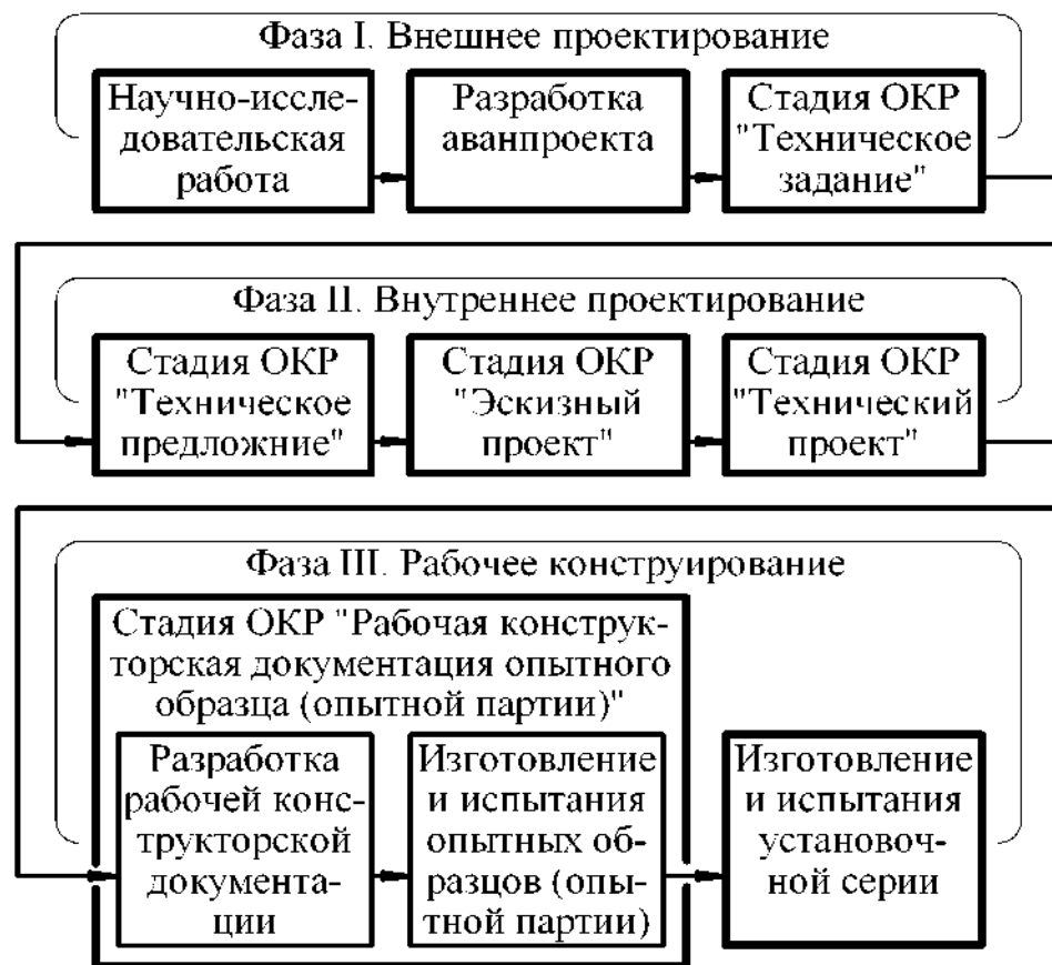
← Рисунок 1.4 – Схема деления стандартного процесса разработки на фазы
